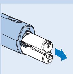
**5** Αφαιρέστε τις επαναφορτιζόμενες μπαταρίες από τη συσκευή.
