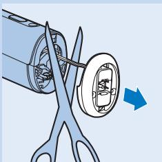
**3** Αφαιρέστε το κάτω μέρος της λαβής και κόψτε τα δύο καλώδια που συνδέουν το κάτω μέρος με τη συσκευή.
